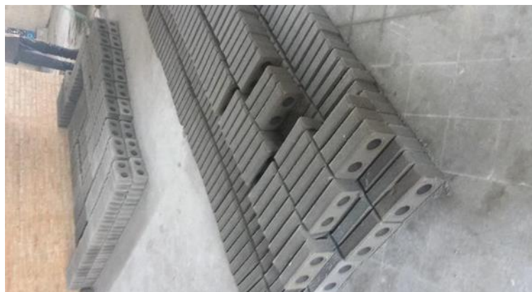
Fig.2. Ladrillo en proceso de fraguado
